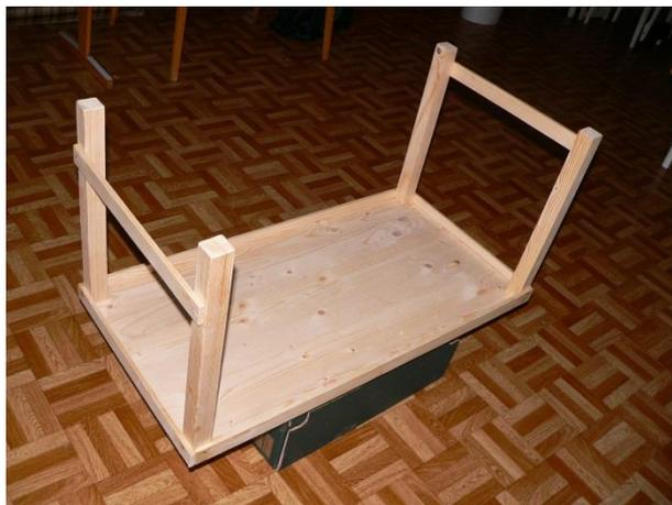
Fissare le colonne di base a tutti e quattro gli angoli del tondino dal basso con pali verticali a vite (5-7 cm di lunghezza). Una vite al centro del pilastro è sufficiente. Quando posizioniamo le colonne, è necessario fare attenzione che siano distanziati dai bordi per quanto riguarda lo spessore delle slate
